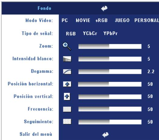
**Modo VIDEO**—Seleccione un modo para optimizar cómo se usará el proyector: **PC**, **MOVIE**, **sRGB** (ofrece una representación del color más precisa), **JUEGO**, y **PERSONAL** (ajusta su configuración preferida). Si ajusta la configuración de **Intensidad blanco** o **Degamma**, el proyector cambiará automáticamente a **PERSONAL**.
