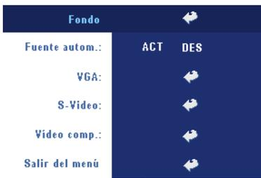
**FUENTE AUTOM.**—Seleccione ACT (valor predeterminado) para detectar automáticamente las señales de entrada disponibles. Si el proyector está encendido y usted pulse **FUENTE**, encuentra automáticamente la siguiente señal de entrada disponible. Seleccione **DES** para bloquear la señal de entrada actual. Si selecciona **DES** y pulsa **FUENTE**, puede seleccionar la señal de
