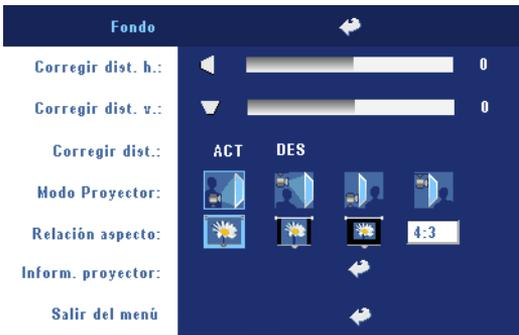
**CORREGIR DIST. V.**—Ajuste la distorsión de la imagen causada por la inclinación del proyector.
